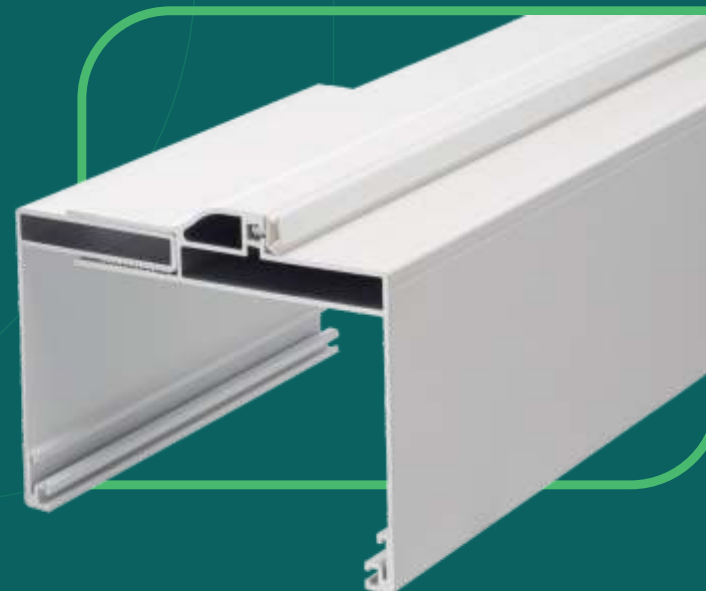
Conjunto marco e alizar Haste com 60 mm e haste com 80 mm. Hastes permitem regulagem até 25 mm.
